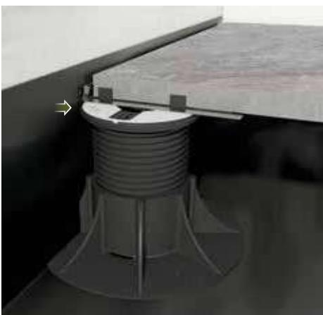
LA CLIP BORDO PIASTRA NASCE PER EVITARE IL CONTATTO DIRETTO TRA LA PIASTRELLA E IL MURO PERIMETRALE NELLE PAVIMENTAZIONI SOPRAELEVATE DA ESTERNO. LA CLIP È REALIZZATA IN ACCIAIO INOX, È PENSATA PER FORNIRE MAGGIORE STABILITÀ ALLA PAVIMENTAZIONE E PER AMMORTIZZARE LE DILATAZIONI, ASSICURANDO UNA FUGA PERIMETRALE FUNZIONALE ED ELEGANTE.
